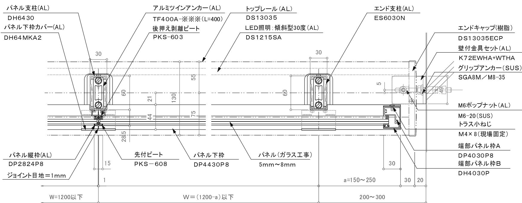
※注意: 支柱ピッチは水平荷重強度及び耐風圧強度により異なります。
