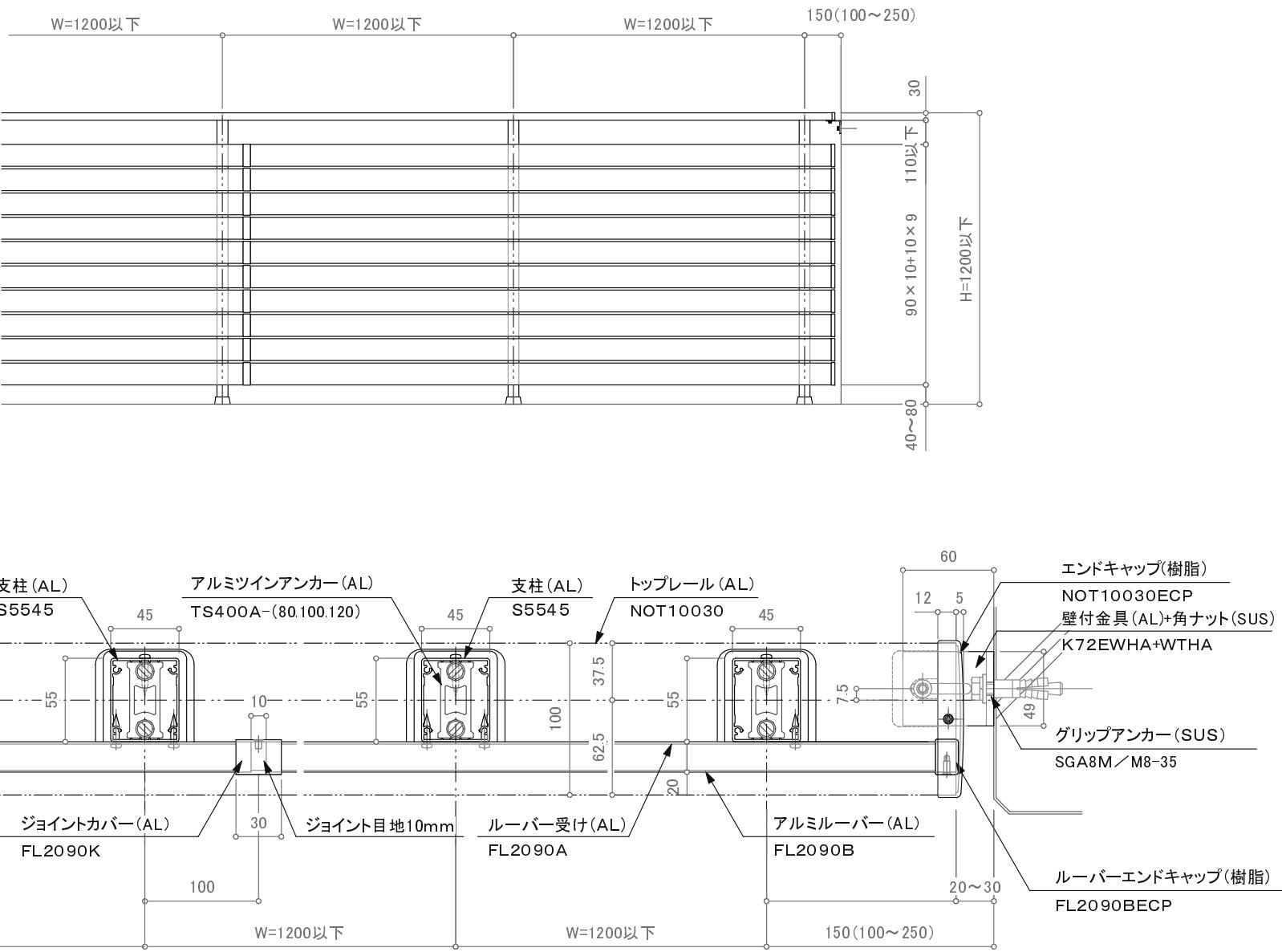
※注意：支柱ピッチは水平荷重強度及び耐風圧強度により異なります。
