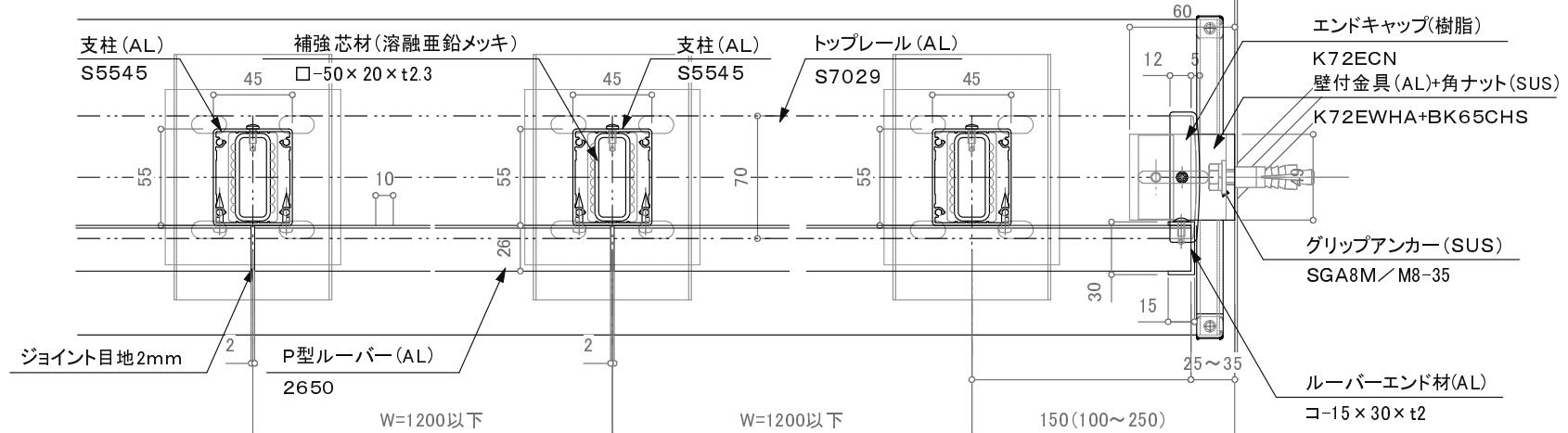
※注意: 支柱ピッチは水平荷重強度及び耐風圧強度により異なります。
