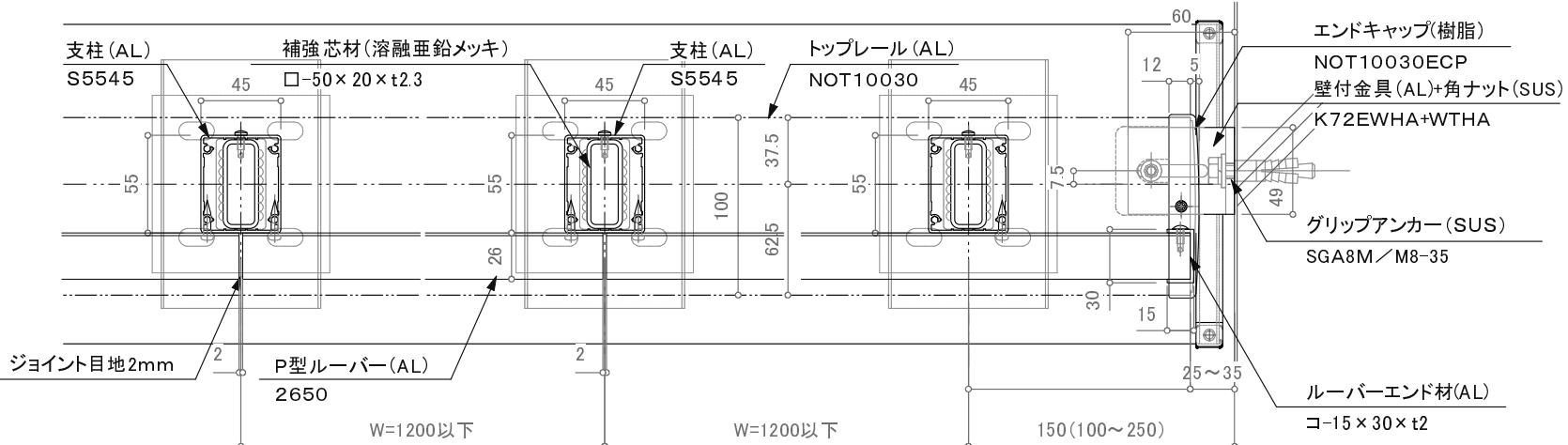
※注意: 支柱ピッチは水平荷重強度及び耐風圧強度により異なります。
