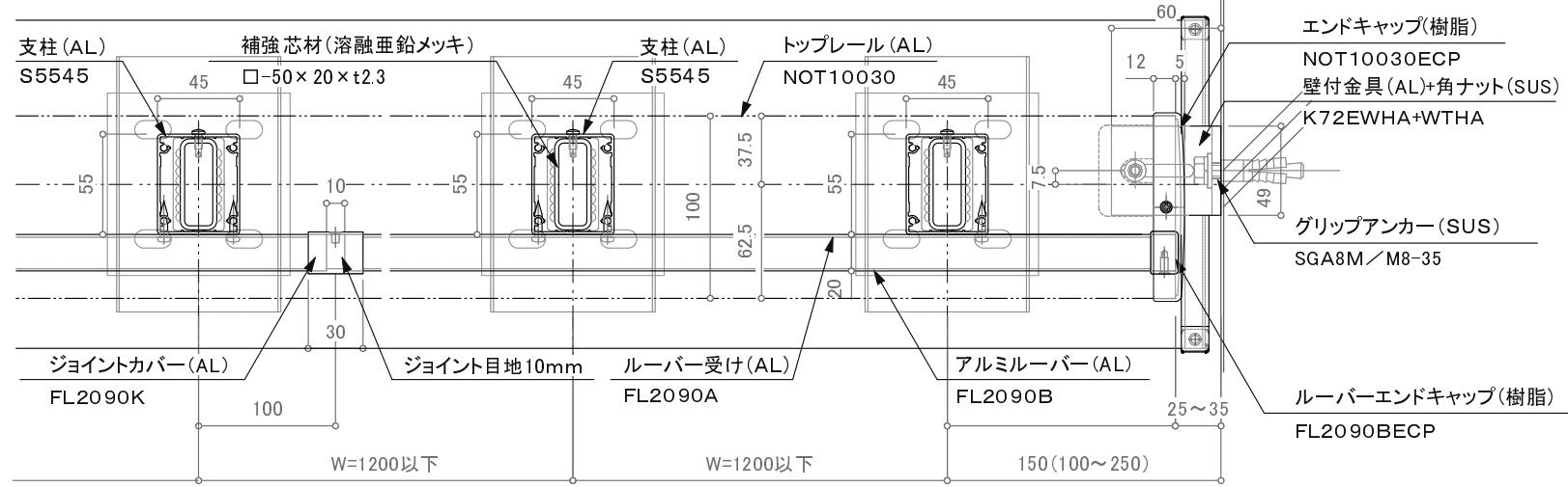
※注意: 支柱ピッチは水平荷重強度及び耐風圧強度により異なります。
