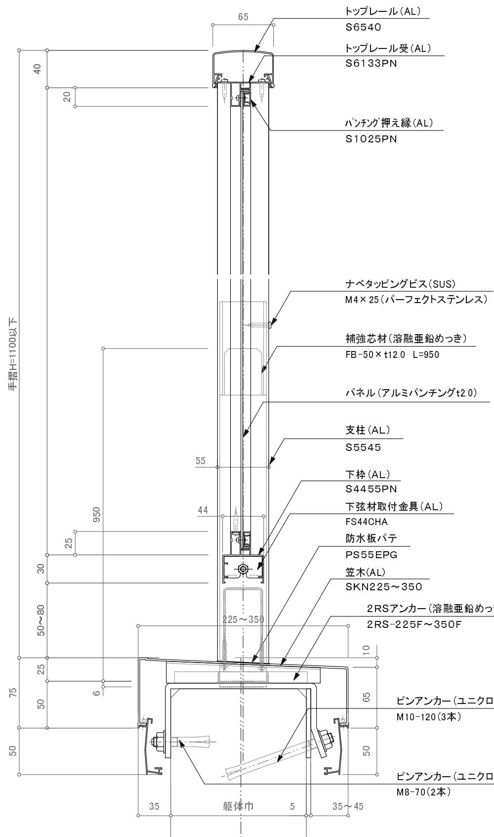
特記事項: 2RSアンカーは軀体巾+5mmで製作します。アンカー芯と柱芯は異なるので注意してください。
